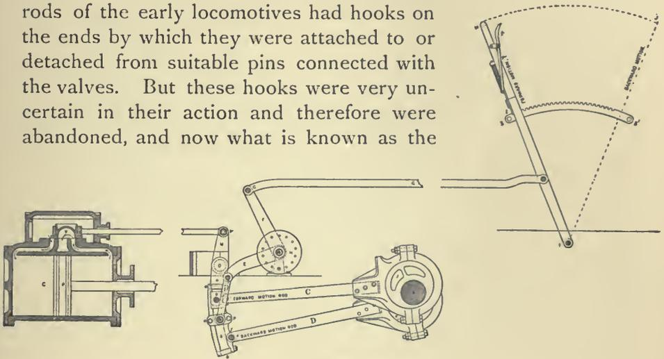
Fig. 24.—Valve Gear.
